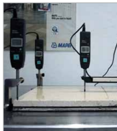
Fig. 2.3 - Prova di stabilità dimensionale mediante incollaggio con adesivo rapido
