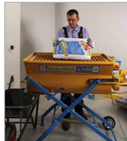
Fig. 3.1 - Miscelazione di massetto in MAPECEM PRONTO
